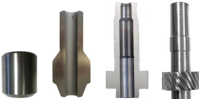
Bild: Die verkürzte umformbasierte Demonstratorprozesskette bildet alle Herstellungsschritte für verzahnte Getriebebohlwellen ab. Quelle: © Fraunhofer IWU.
